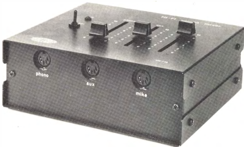
Vista frontale dell'UK 716 dell'Amtron a realizzazione ultimata, si notino le prese d'ingresso.
