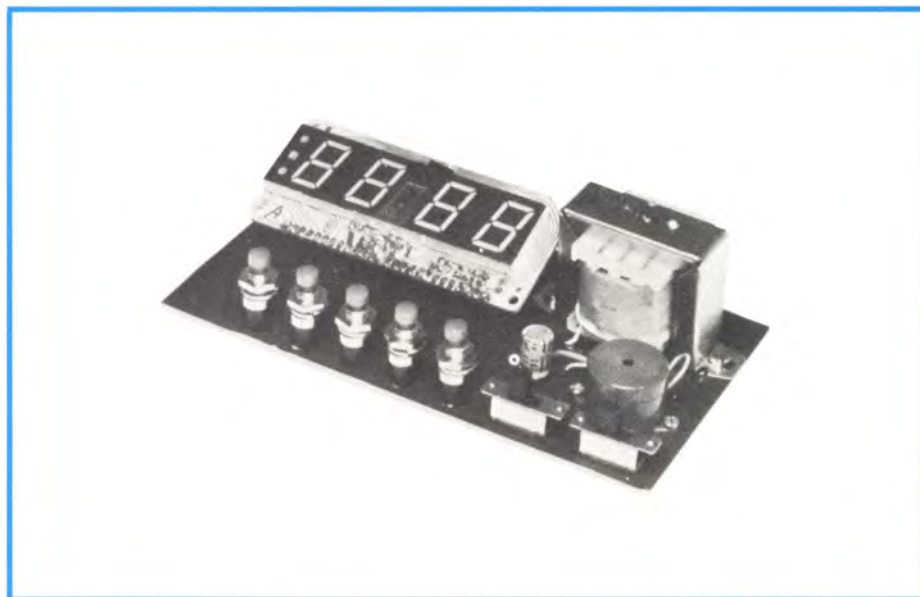
Aspetto dell'orologio digitale KS 400 a realizzazione ultimata.
